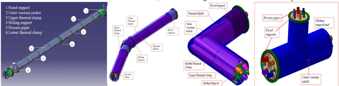
Figure B.2.8 (a) Straight section (b) Elbow section (c) C – section (d) T - Section
